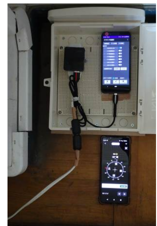
図7 豊橋市内の小学校に設置したスマホ地震計
