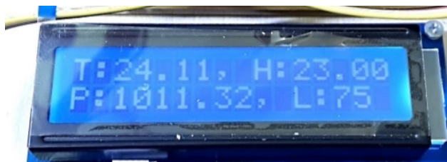
図8：センシング情報の確認用モニタの実装
