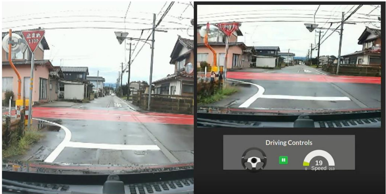
図12 生成された一時停止標識（左：実車映像、右:Drive GAN）
