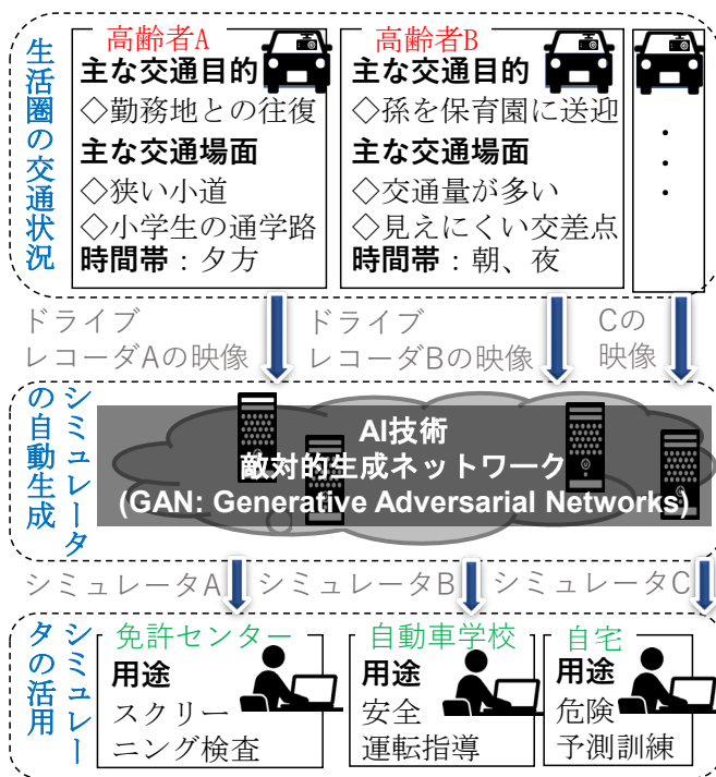
図2 AIによるシミュレータの自動生成の流れと活用
