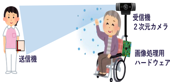
図2：2次元カメラを受信機として利用（従来）
