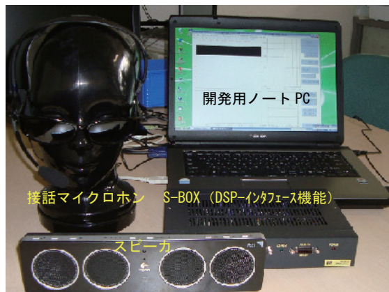
図13 スタンドアロン型音声復元装置の開発システム概観(今後の課題)
