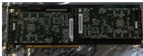
図 9 実験に用いた FPGA ボード (Celoxica 社 RC2000)
