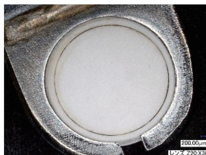
図7 汚染された手術器械の洗浄後の外観
