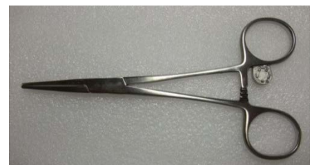
図 1 RFID タグ付き手術器具の外観
