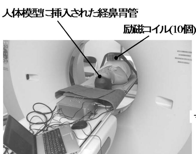
図 3 人体模型を使用した検証実験
