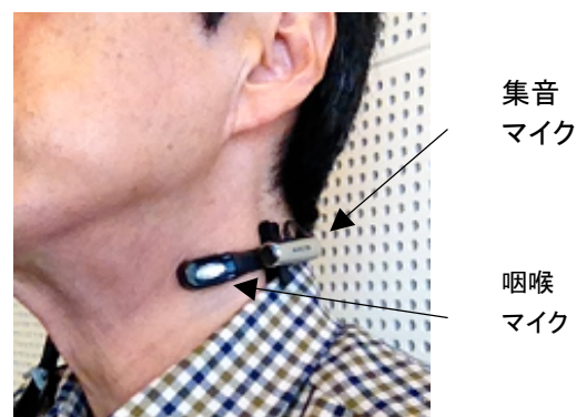
図1 咽喉マイクと集音マイクの同時装着の様子
