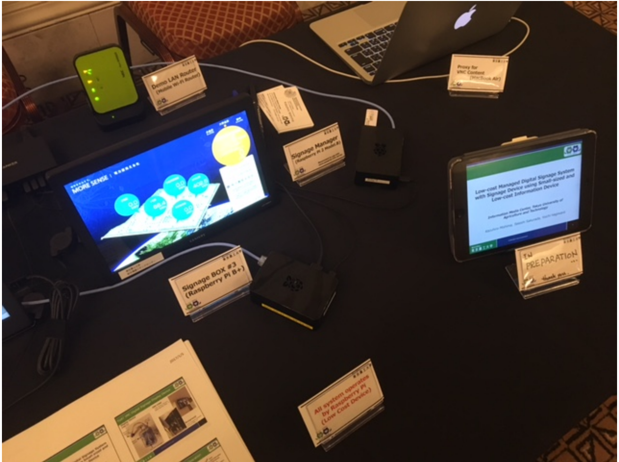
図：CCNC2017 デモンストレーションでの Raspberry Pi による集約管理システムの実際の動作 (画面中央、白い USB メモリが刺さったデバイスが集約管理システムの動作する Raspberry Pi)
