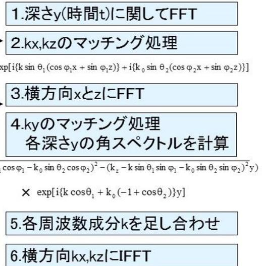
図3. 平面波送信時の受信ダイナミックフォーカシングのフローチャート。
