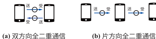
図 1 全二重通信の基本的な伝送モード (a) 双方向全二重通信モード (b) 片方向全二重通信モード
