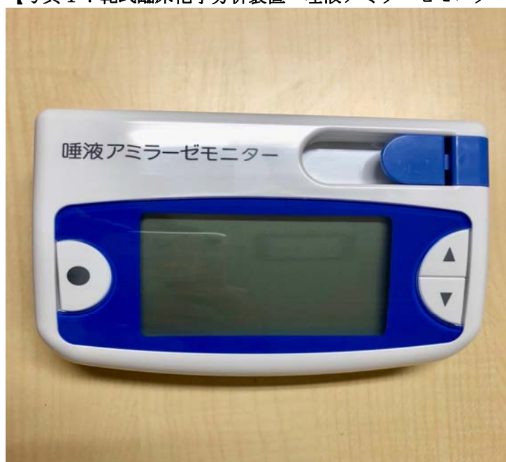
【写真1：乾式臨床化学分析装置 唾液アミラーゼモニター（ニプロ製）】
