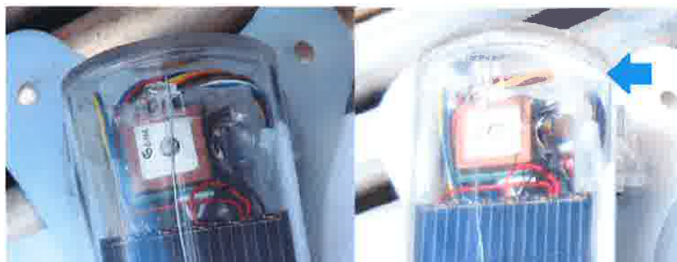
図18 気温上昇に伴う結露 密閉されているが結露が発生 (←)
