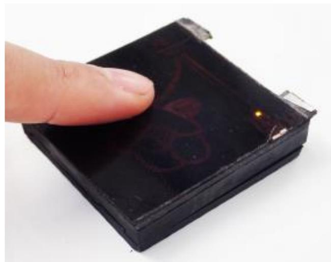
図18. 試作した漆タッチモジュール
