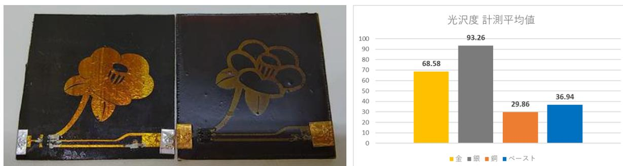
図11. 左: 漆回路の比較(左: 金, 右: 銀ペースト) 右: 光沢度の測定結果
