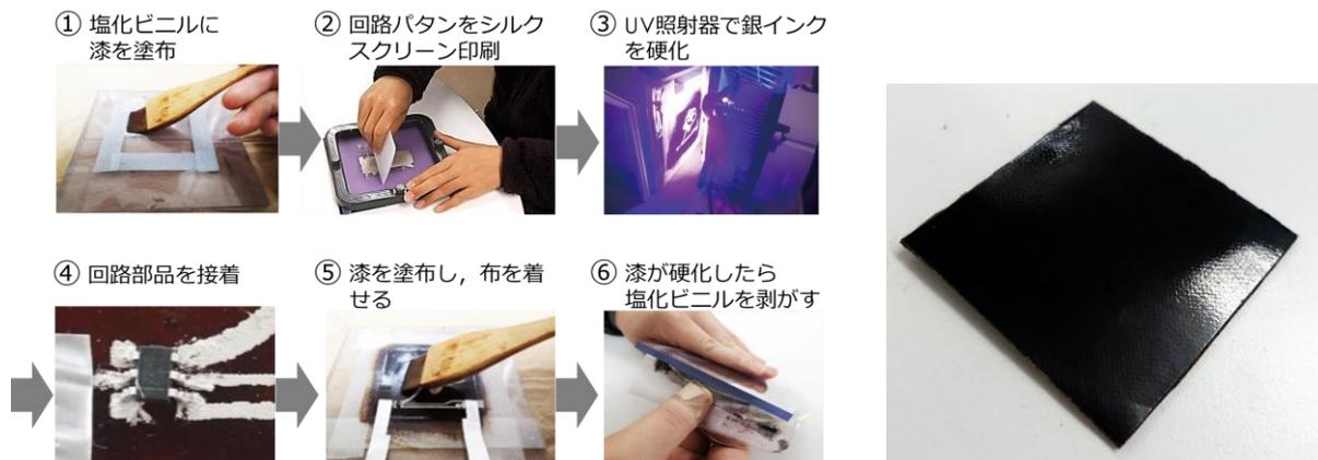
図8. 左：実際の作業手順 右：本手法で作成した漆回路の表面
