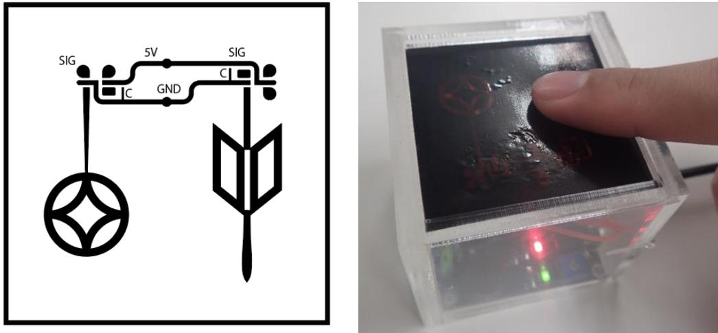
図19. 左：小紋を用いた回路デザイン 右：試作したモールス信号入力システム
