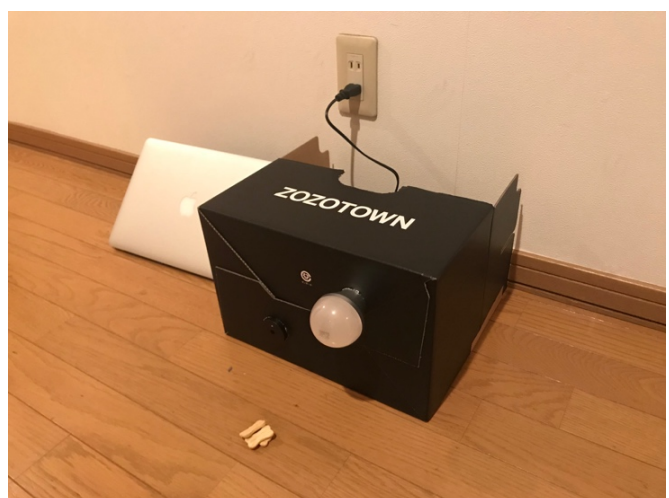
図 22 威嚇機器の設置の様子(室内)
