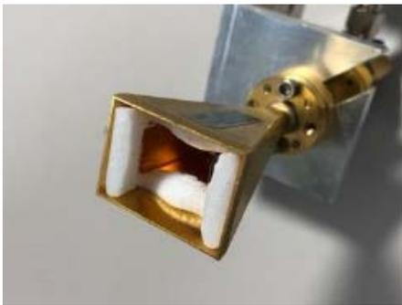
図8 ミリ波レンズの試作結果
