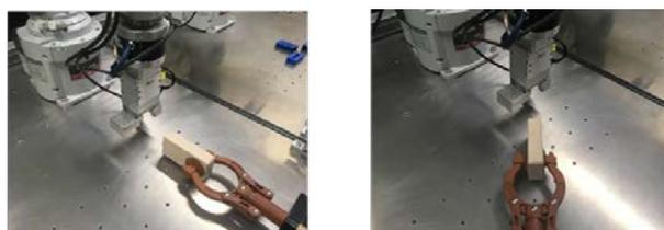
図6 人がマジックハンドでロボットに物体を手渡す作業
