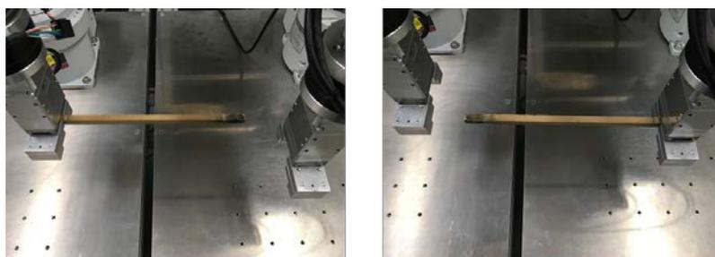
図5 ロボット間で物体を手渡す作業
