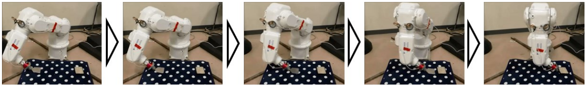
図 2.15 実験によるすくい上げ動作時のスナップショットの 1 例 ( \dot{q}^{max} = [0.4 \text{ m/s}] )
