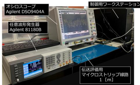
図 15 オシロスコープと任意波形発生器と連携させた実測システム
