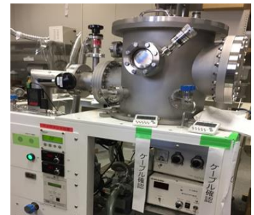
図4. RF マグネトロンスパッタ装置
