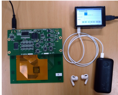
図1 開発中のウェアラブル点字リーダーの全体像
