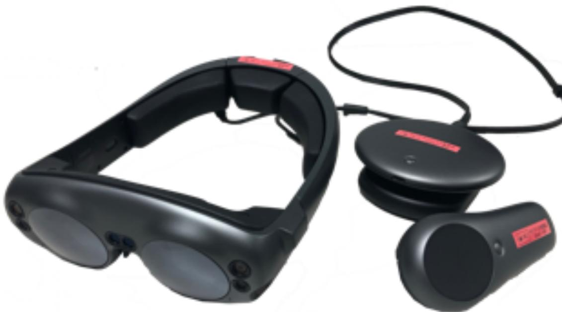
図 1 光学シースルー型 HMD (Magic Leap 1, Magic Leap 社)
