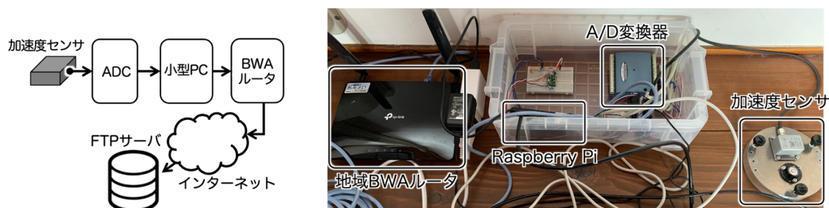
(a) 開発した地域 BWA 連携の固有振動数計測システムの外観
