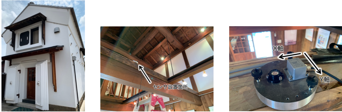
図7 土蔵における加速度センサによる常時微動計測の概要
