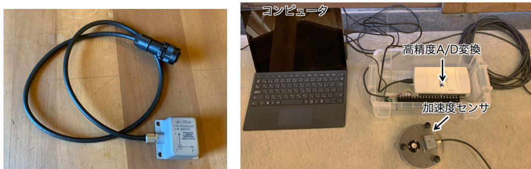
図 2 常時微動計測システムの概要 (左図：加速度センサの外観、右図：システムの構成)
