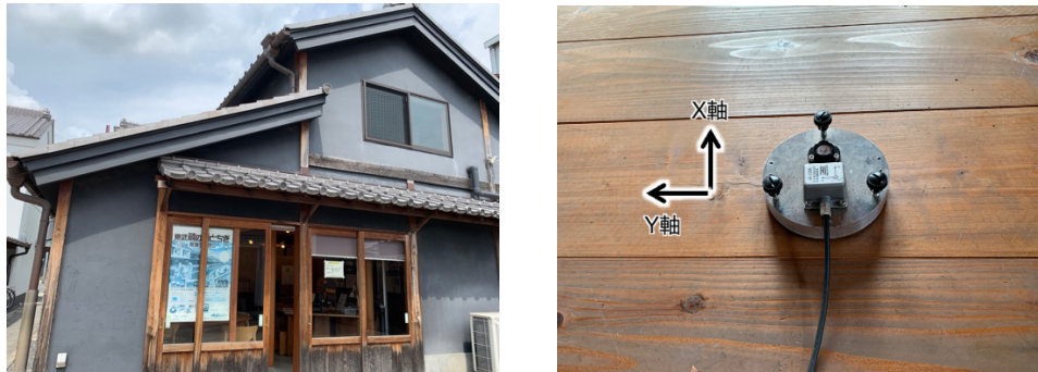
図 4 見世蔵における加速度センサによる常時微動計測の概要
