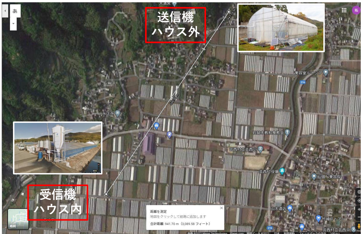
図9 高知県安芸郡芸西村における2地点ハウス間(940m)のLPWA通信実験
