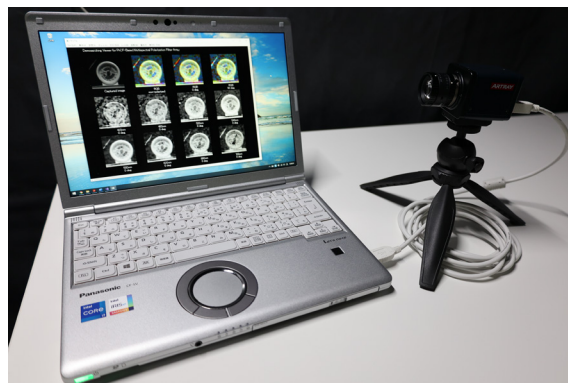
図5: 実装したリアルタイム分光・偏光・RGB画像復元システム
