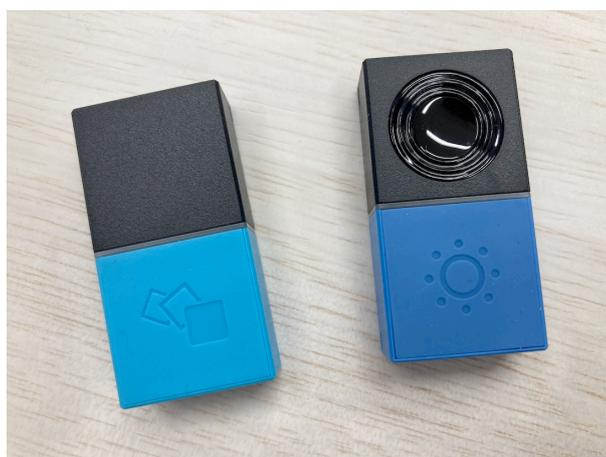
図 4 MESH™ の「動き」ブロック（左）と「明るさ」ブロック（右）
