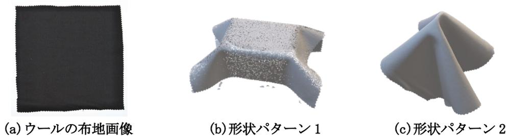
図6: ATOS Core 500 を用いた布地のスキャン結果(ウール素材)
