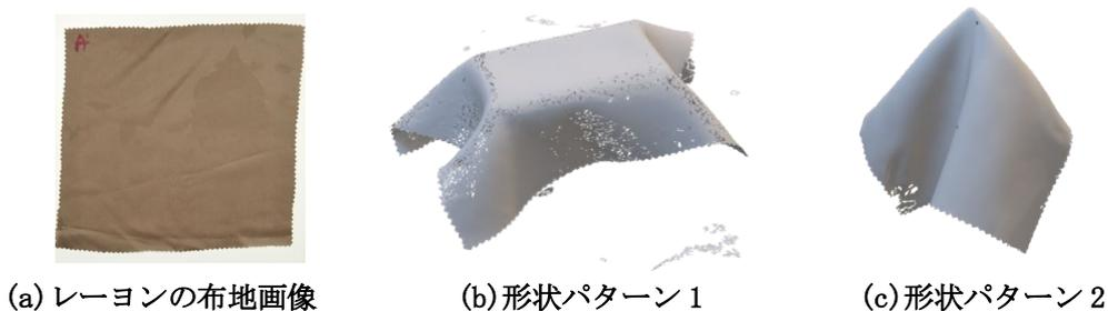
図4: ATOS Core 500 を用いた布地のスキャン結果(レーヨン素材)
