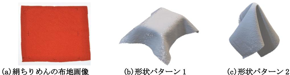
図5: ATOS Core 500 を用いた布地のスキャン結果(絹ちりめん素材)
