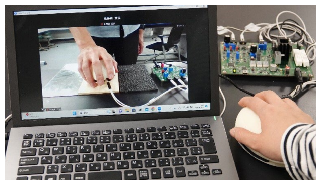
図2. マウス型装置を用いた遠隔触覚伝達
