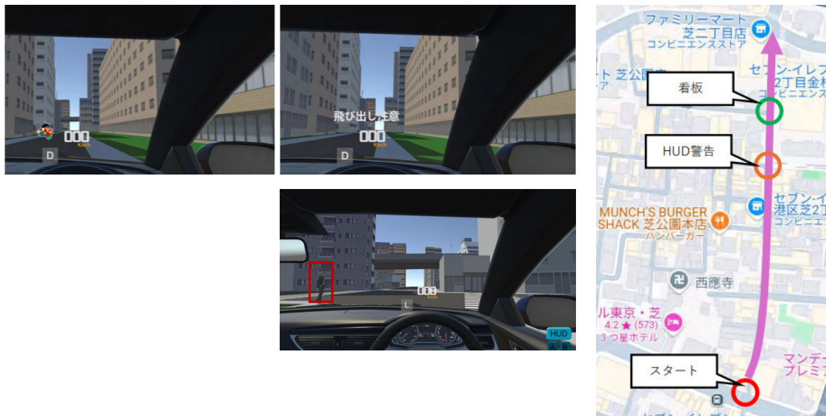
図 2 ドライビングシミュレータ実験のルートと走行画面 (上：仮想現実画面，下：歩行者の接近)
