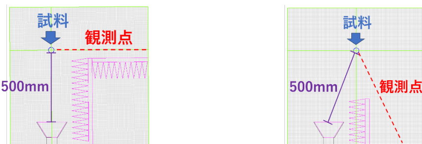
図 3 OpenFDTD でモデリングした測定環境 (左：L字配置モデル、右：V字配置モデル)
