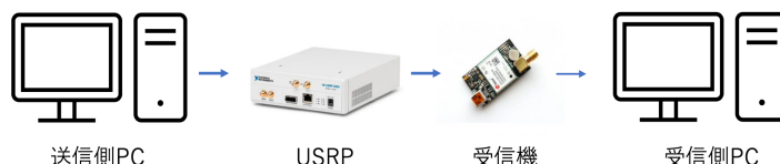
図 1 USRP での信号実装概略図
