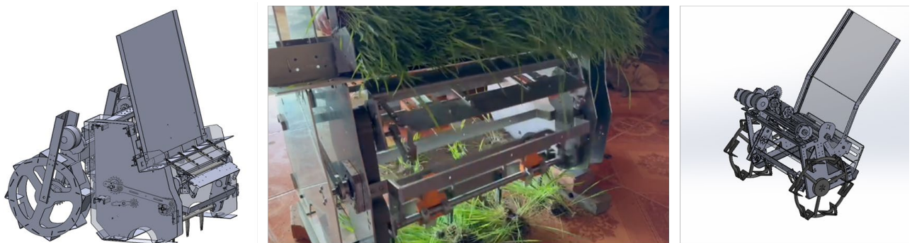
図 1：（左）田植えロボットの設計図、（中央）カンボジアにおけるフィールドワークで苗を使って田植えロボットを実際に動作させた実験の様子、（右）耐久性向上のために行った機構設計の改良
