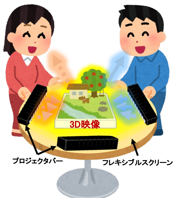
図 1 裸眼 3D ディスプレイシステムのコンセプト
