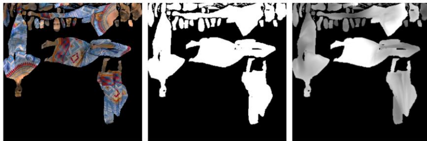
図 1 V-PCC におけるパッキング画像の例。左: テクスチャ情報, 中央: 占有情報, 右: 幾何情報
