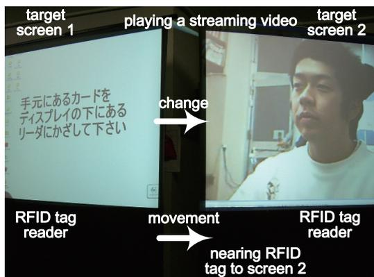
(b) 60 インチスクリーンディスプレイによる実験系
