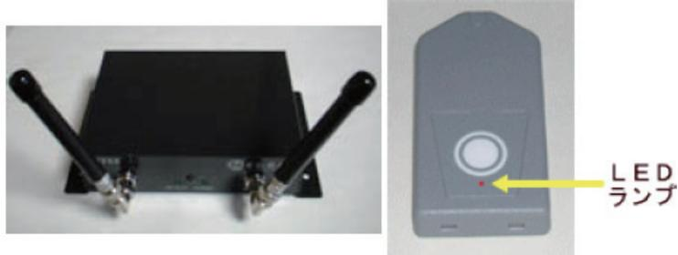
図 2：アクティブ型無線 IC タグ（右）とその受信機（左）
