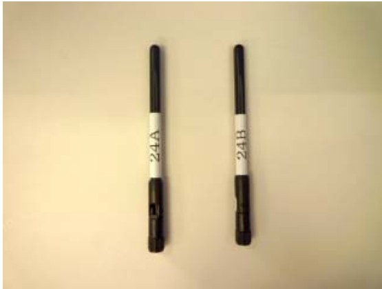
図5 2.4GHz帯ロッドアンテナ (A:Tx用, B:Rx用)
