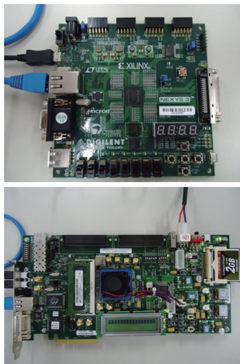
図 7: FPGA 評価ボードと Ethernet の接続
