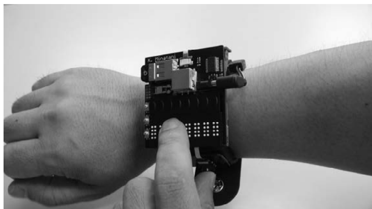
図 6 腕時計型点字ディスプレイを装着した状態
