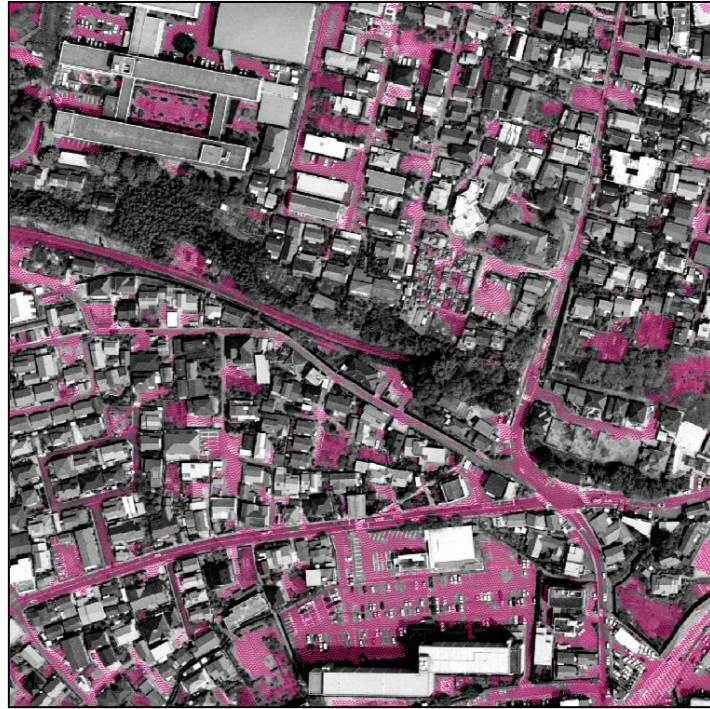
図 8 提案法によって抽出された地面の点
