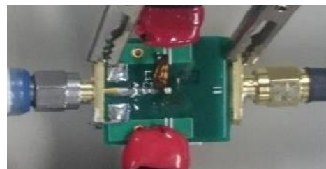
図 5 送受信対称インピーダンス整合型伝送系の基板写真
