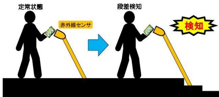
図 10 段差検知の様子
