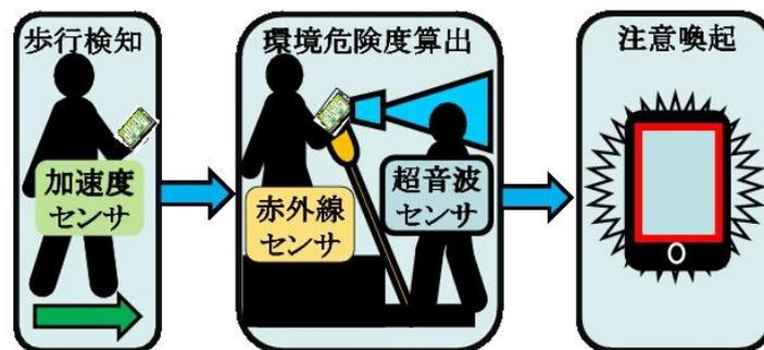
図7 環境危険度検知システムの概要
