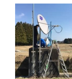
図10 評価実験に用いる衛星通信用のアンテナ設置
