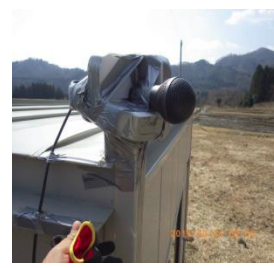
図12 システムの動作確認用に設置したマイクセンサ
