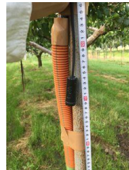
図 3 圃場用屋外温度及び湿度センサ
